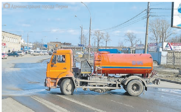
На спецтехнику установили поливальные устройства и бункеры с водой
